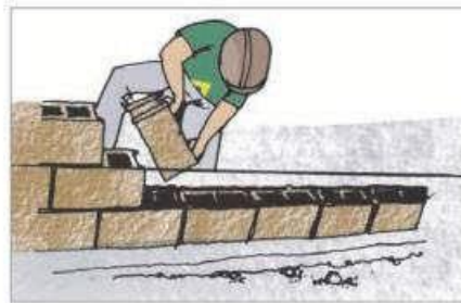
2 Esticando a linha e iniciando o assentamento da fiada
